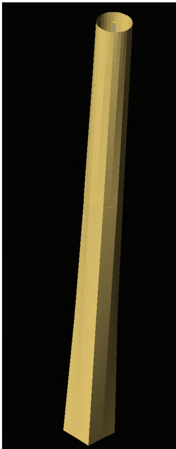
FIGURA 13. Columna de base quadrada, que es transforma en un octàgon, en un polígon de setze costats i s'acosta al cercle cap al cap superior.
